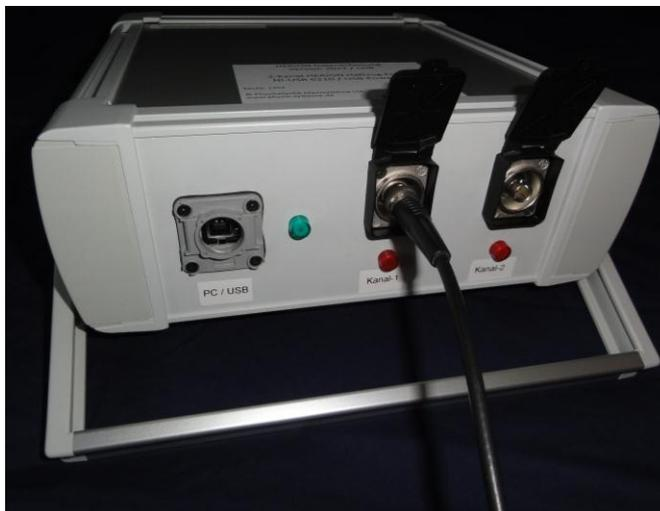
Es können gleichzeitig zwei verschiedene HERION Abzugsgeräte angeschlossen sein, das Programm kann jedoch nur mit einem von beiden Geräten die Messung durchführen.
